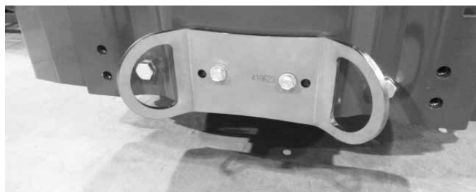
Priväzovacia konzola A418623 nainštalovaná na zadnom nárazníku alebo protizávaží
