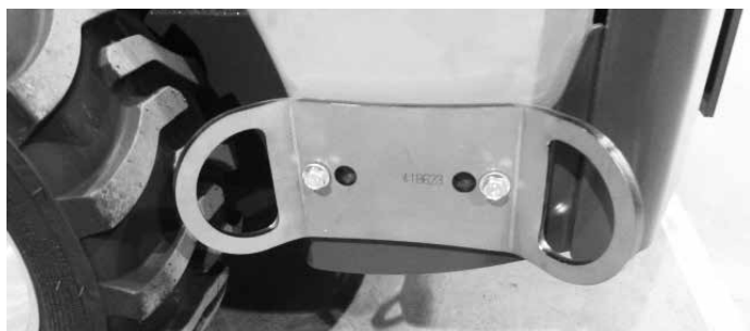
Priväzovacia konzola A418623 nainštalovaná na boku zadného rámu. Na bočnú inštaláciu sú potrebné dve konzoly.
